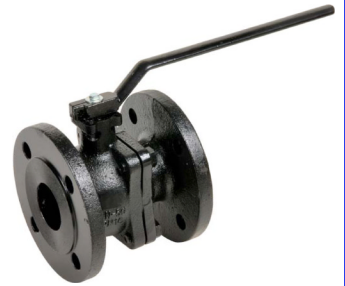
gietijzer PN16 volle doorlaat fig 148 : DN15-DN200 inox bol PTFE dichtingen temp. : -10°C/+180°C tot DN100 : F4 inbouw lengte > DN100 : F5 inbouw lengte
