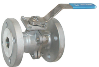
inox 150 lbs volle doorlaat PTFE + 15 % GF dichtingen fig 195 : 1/2" - 8" temp. : -30°C/+180°C voorzien van iso 5211 topflens voor rechtstreekse montage voorzien van wormwielkast op aanvraag
