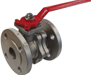
inox 300 lbs volle doorlaat fig 196 : 1/2" - 6" inox CF8M bal PTFE TFM1600 dichtingen temp. : -50°C/+250°C voorzien van iso 5211 topflens inbouw lengte volgens ASME B16.10
