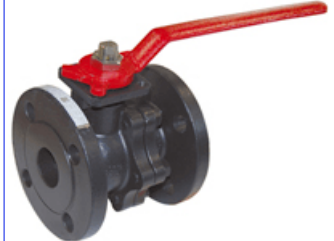
staal 300 lbs volle doorlaat fig 194 : 1/2" - 6" inox CF8M bol PTFE TFM1600 dichtingen temp. : -29°C/+250°C voorzien van iso 5211 topflens inbouw lengte volgens ASME B16.10
