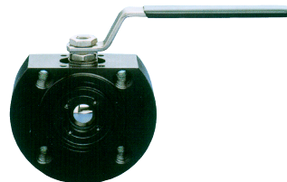
staal : PN16 volle doorlaat fig 181.1 : DN15-DN200 fire-safe dn DVGW-gas op aanvraag inox bol / PTFE dichtingen temp. : -20°C/+180°C voorzien van iso 5211 top-boringen
