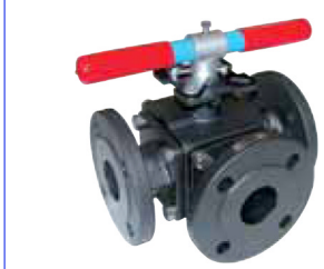
staal PN16 volle doorlaat L- of T-boring fig 191 : DN50-DN150 inox 316 bol en spindel 4 PTFE versterkte dichtingen temp. : -30°C/+180°C voorzien van iso 5211 topflens voor rechtstreekse montage
