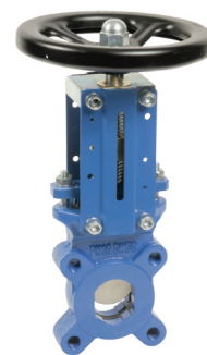
fig 387 plaatafsluiter / flenzen PN10 huis gietijzer + rilsan coating vler nodulair gietijzer vernikkeld 2-zijdig dichtend DN50 - DN400 NBR dichting : temp. : -10°C/+80°C bediening met handwiel, niet stijgend niet-stijgende spindel
