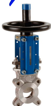
fig 380I plaatafsluiter / flenzen PN10 huis RVS316 plaat en spindel RVS316 1-zijdig dichtend DN50 - DN400 EPDM dichting : temp. : -15°C/+110°C bediening met handwiel, niet stijgend stijgende spindel
